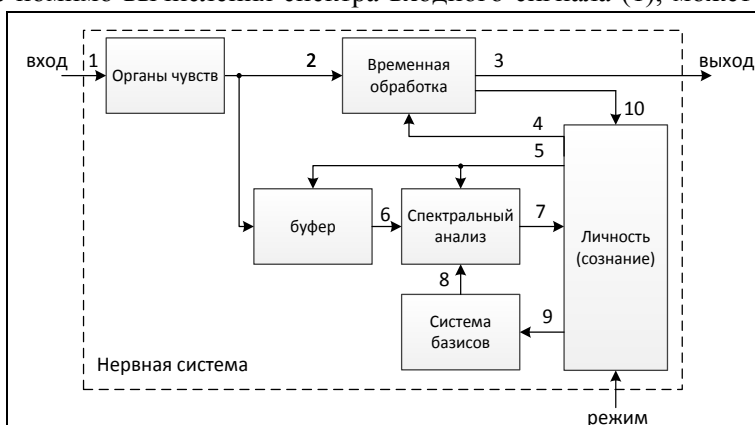
Рис. 6. Схема модели обработки сигналов: 1 — входные данные; 2 — сформированные сигналы от органов чувств; 3 — выходные данные после временной обработки; 4 — задание вида импульсной характеристики; 5 — управление работой буфера и спектральным анализом; 6 — сигнал из буфера в блок вычисления спектра; 7 — результат вычисления спектра; 8 — система базисов; 9 — задание системы базисов.
