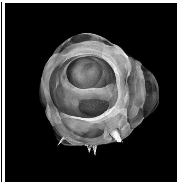
Рис. 8. Ядерный взрыв в первые мгновенья. В таком виде он ненаблюдаем для невооруженного глаза.
