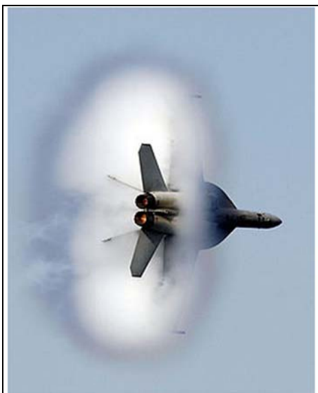
Рис.17. Истребитель F-18 в трансзвуковом режиме. Так выглядит преодоление звукового барьера.
