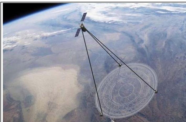
Рис. 22. Планируемый мембранный телескоп с полимерной оптикой.
