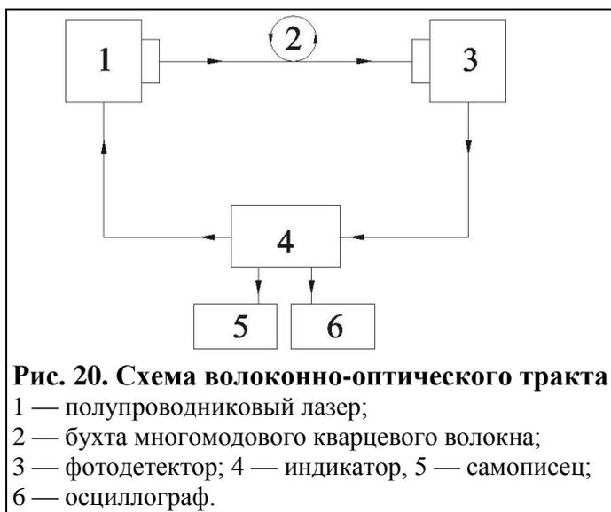
Рис. 20. Схема волоконно-оптического тракта
