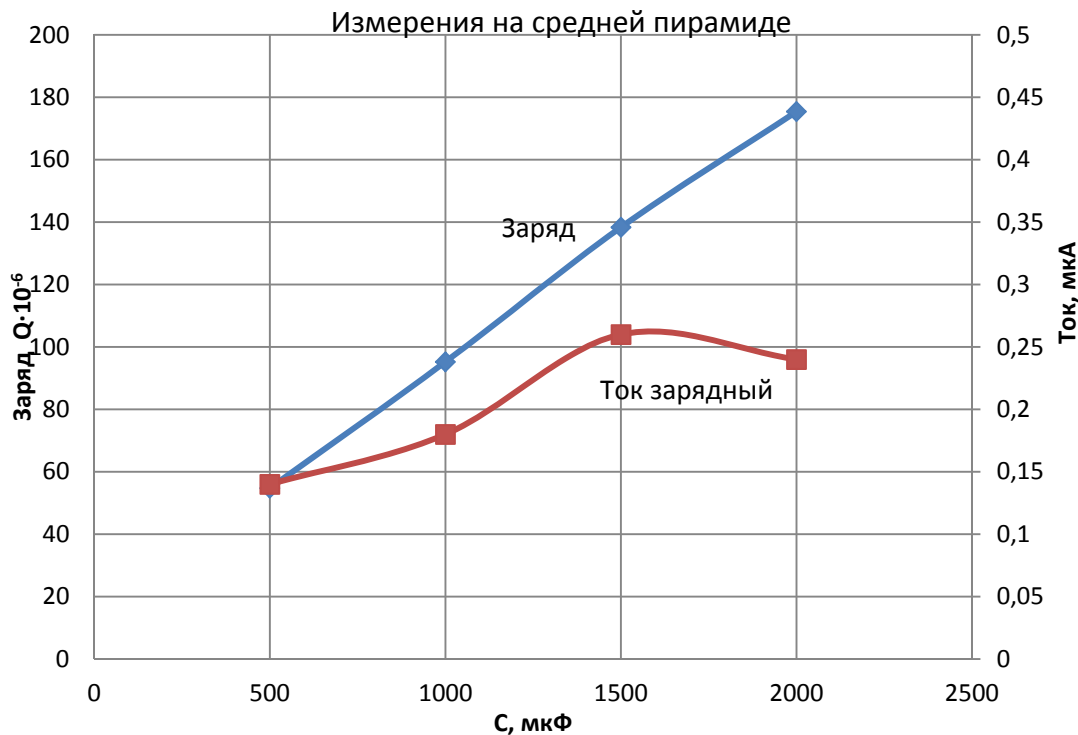
Рис. 3. Изменение величины накапливаемого заряда Q_c и тока в средней пирамиде при отсоединении (либо присоединении) заборных конденсаторов.
