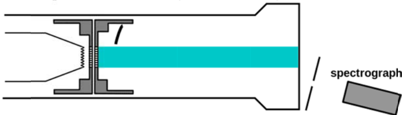
Рис. 12. Схема эксперимента Айвса и Стилуэлла.
